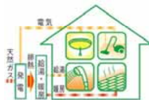
燃料電池システム
